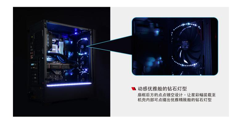
■ 幻彩 Addressable RGB 主板灯效同步控制可连接主板上的标准 4 Pin (+5V/D/-/G) Addressable RGB 端口,星彩蝠的幻彩灯型及灯色将同步随主板变化
