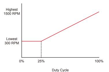
PWM 智能转速控制,依据系统负载状态 自动调整转速,并提供 300PRM 起转低 躁音的优异表现
